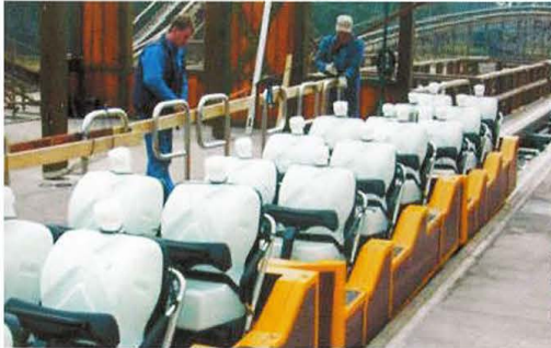
Abb. 10 Testbeladung der Wagen bei der Abnahme durch den TÜV. Beim inoffiziellen Probelauf hob es die „beinlosen“ Personenattrappen (gewöhnliche Sandsäcke) durch die spektakulären Fliehkräfte an einigen Stellen der Fahrt geradezu aus den Sitzen.
