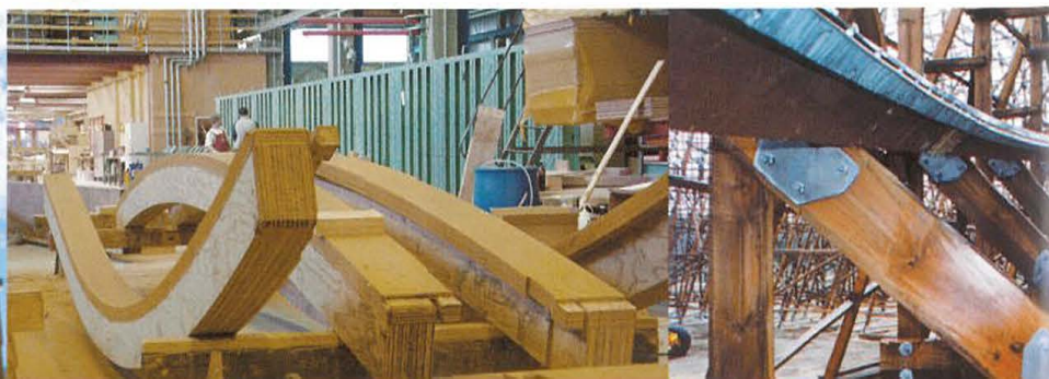
Abb. 6 Räumlich gekrümmte Schienelemente
